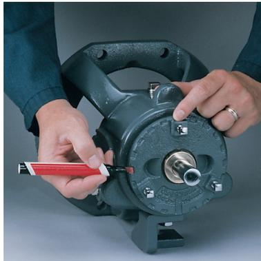
**Paso 2:** Seleccione la tolerancia de ajuste de impulsor. Cada ranura en el anillo del soporte del rodamiento representa exactamente una holgura de 0.10 mm (0.004 pulg.) Para un ajuste de impulsor de 0.5 mm (0.020 pulg.), cuente cinco muescas a la izquierda.
